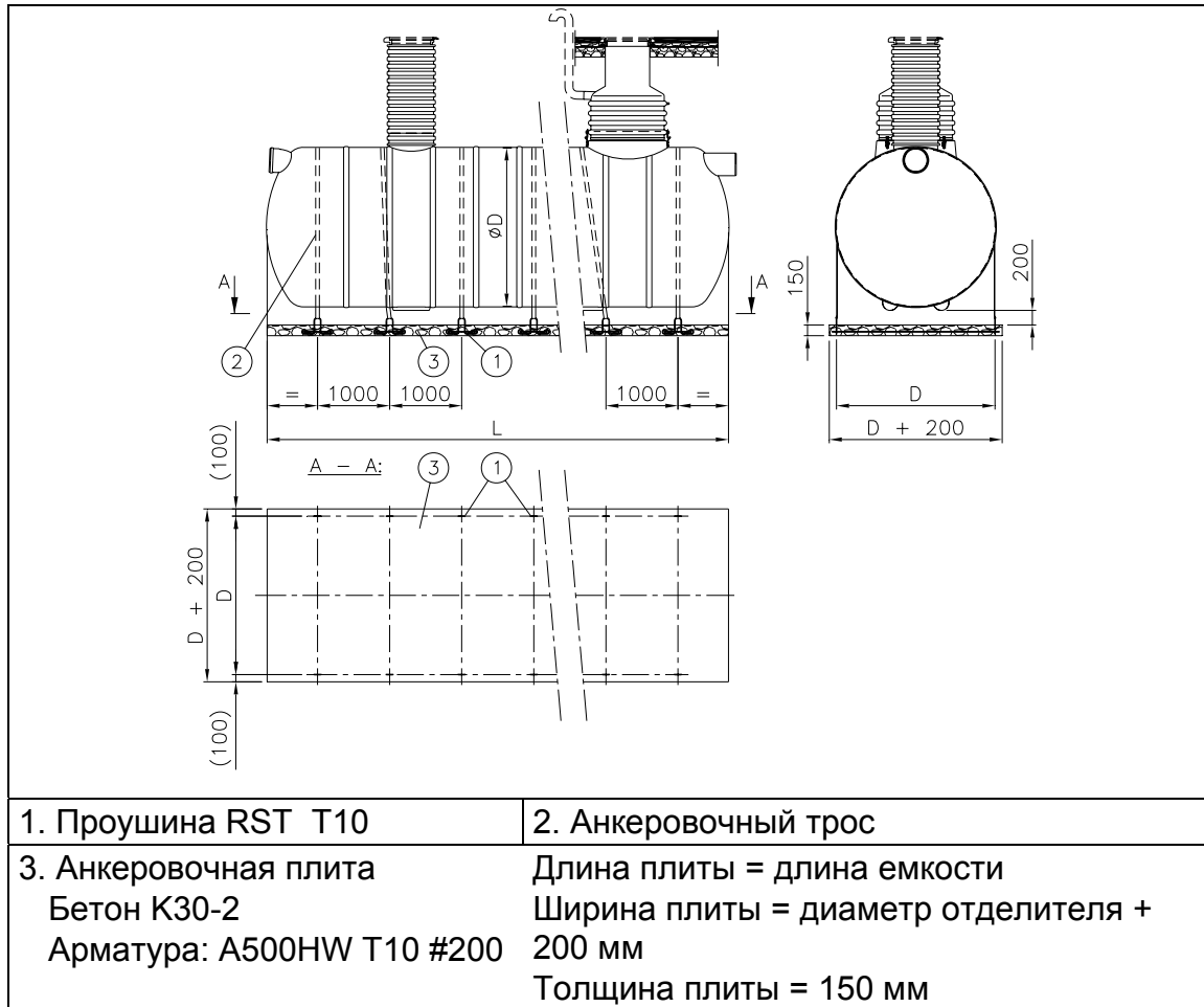
Рис. 3. Установка отделителя на бетонной плите
